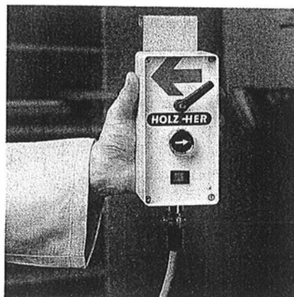
*Mit der Kombination elektrische Verschiebeeinrichtung und elektronischem Maßanschlag-System perfektionieren Sie Ihren Plattenzuschnitt in äußerst rationeller Weise, verbunden mit höchstem Bedienungskomfort. Mit nur einem Besäumsschnitt an der oberen Plattenkante beginnen Sie, Ihre Platten von oben nach unten aufzuteilen: Sägeblatt-Stärke wegen der Schnittfuge in das Maßanschlag-System eingeben, Anschlag auf die Plattenkante aufsetzen, Maßanzeige nullen, festgeklemmtes Sägeaggregat lö-*
