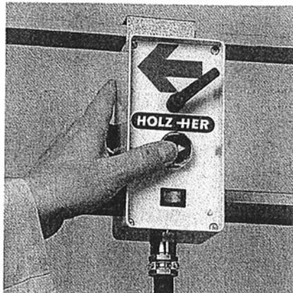
*Mit diesem Steuergerät verschieben Sie Ihre Platten einfach und schnell. So brauchen Sie nur noch einen Mann für die Zuschnittarbeiten.*
