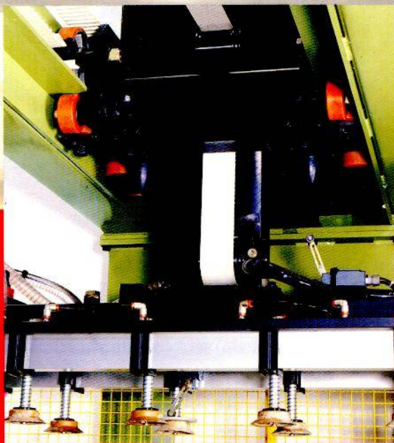
Dispositivo di traslazione carro portaventose • Dispositif pour le déplacement du chariot porte-ventouses • Transfer device with suction cups holder frame • Verchiebungsvorrichtung des Saugnapfenrahmens
