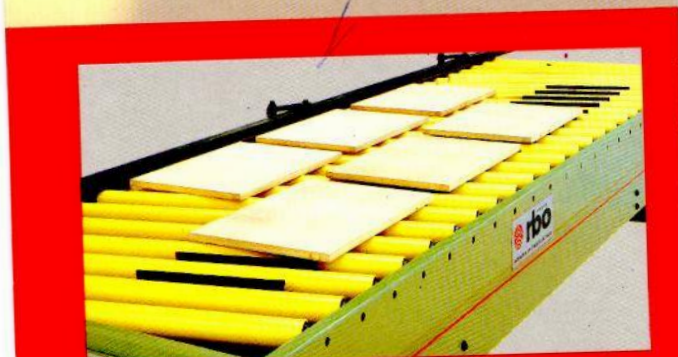
Dispositivo di carico in doppia fila • Dispositif de chargement en double rang • Feeding device to feed panels in a double row • Zuführungsvorrichtung in Doppelreihe
