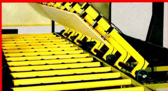
Dispositivo di ribaltamento barre post / forming • Dispositif de retournement panneaux post-formage • Post-forming panels overturning device • Saugnapfenwender für Post-forming Werkstücke.
