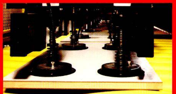
Telaio a ventose per prelievo di pannelli di grandi dimensioni. • Châssis à ventouses pour le prélèvement de panneaux de grandes dimensions. • Suction cup frame to draw large panels. • Saugnäpfframen zur Entnahme großer Platten.
