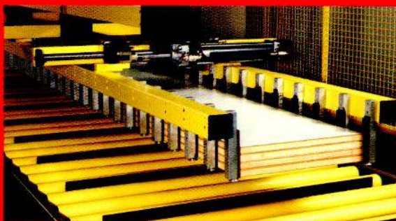
Telaio a pinze per scarico pacchi di pannelli da sezionatrici. • Châssis à pinces pour le déchargement de piles de panneaux des scies à panneaux. • Pincer frame to stack packs of panels from panel saws. • Greiferrahmen zur Entladung von Plattenpacken vom Plattenaufteilsäge.
