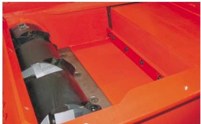
leistung erreicht wird. Die Schublade ist mit Abstreifleisten versehen, die einen unerwünschten Materialeinzug zwischen Schublade und Maschinengehäuse verhindern.
