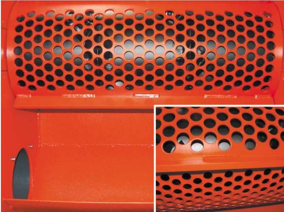
Die Zerkleinerung des eingebrachten Materials erfolgt zwischen den Rotormessern und einer statischen Gegenmesserleiste. Das zerkleinerte Material wird durch das unterhalb des Rotors angebrachte Sieb ausgetragen. Der variable Siebloch-Durchmesser (10- 40 mm) bestimmt die gewünschte Schnittzelgröße.
