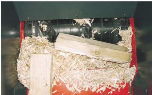
Die Materialzufuhr erfolgt über eine hydraulisch angetriebene Schublade, die das Material lastabhängig gesteuert auf den sich drehenden Rotor drückt, wodurch eine konstante Zerkleinerung und somit eine hohe Durchsatz-
