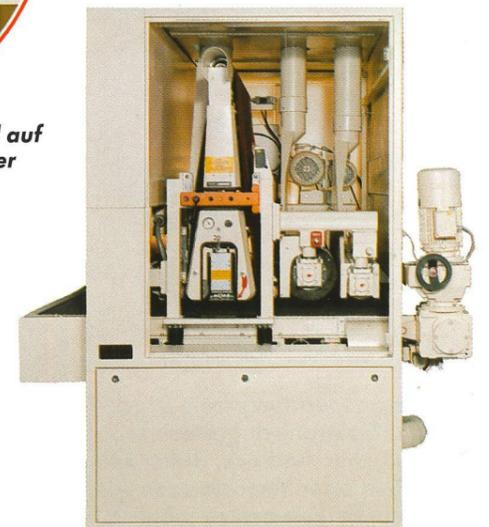
Das Längsschleifaggregat und zwei Bürstenaggregate
