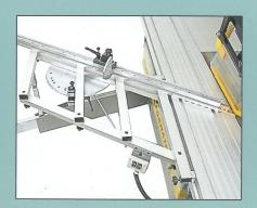
Der Parallelogramm-Quertisch kann beidseitig bis 45° verstellt werden, einschließlich Winkelanschlag. Das heißt: Sie haben immer die volle Tischlänge zur Verfügung. Und die Winkelverstellung? Genauigkeit 0,01 Winkelgrad!
