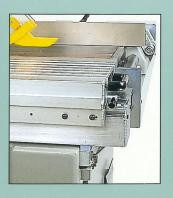
Der Rolltisch mit Laufschiene kann soweit zurückgestellt werden, daß er mit dem Maschinentisch bündig ist. Zum Sägen am Parallelanschlag müssen Sie nicht über den Rolltisch gebeugt arbeiten. Bei zurückgestelltem Rolltisch sind noch Querschnitte bis 1,7 Meter Länge möglich.
