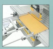
Parallelschneideinrichtung für Schnittbreiten von 50 bis 700 mm. Wird zusammen mit dem auf das gleiche Maß eingestellten Ablänganschlag eingesetzt. Unentbehrlich zum Schneiden von 2 gegenüberliegenden schrägen Kanten.
