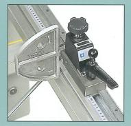
Ablänganschlag mit Griffradverstellung und elektronischer Maßanzeige, Batterielebensdauer ca. 6 Jahre. Winkelanschlag für Winkelschnitte zum Sägeblatt hin verschiebbar. Kann auf beiden Seiten des Parallelogrammtisches eingesetzt werden.
