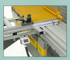
Die Taster der pneumatischen Schnellabsenkung für Sägeblätter bis 350 mm Durchmesser lassen sich am Parallelogrammtisch und am Ende des Rolltisches einhängen. Zwei weitere parallel geschaltete Taster befinden sich in der Bedientafel.
