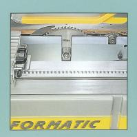
Anwendungsbezogene Technik kommt von KÖLLE. Beispiel: die Vorritzsäge. Per Drucktaster auf- und abschwenkbar. Sie können wechselweise ohne Zeitverlust schneiden – mit oder ohne Vorritzsäge.
