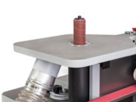
Schleifen von Innenrundungen
