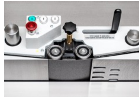
Schleifen von Außenrundungen
