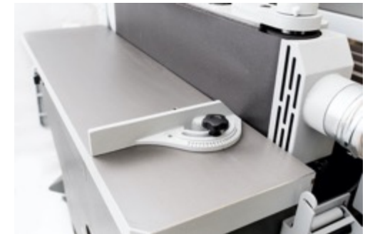
Schleifen bzw. Herstellen von Winkeln
