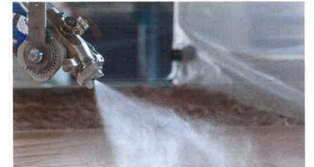
**Verringerung von Overspray:** Eine optimale Lüftführung in Kombination mit einem großen Absaugvolumen sorgen für einen gleichmäßigen Lackauftrag, eine hohe Übertragungsrates und eine geringe Verschmutzung der Maschine.
