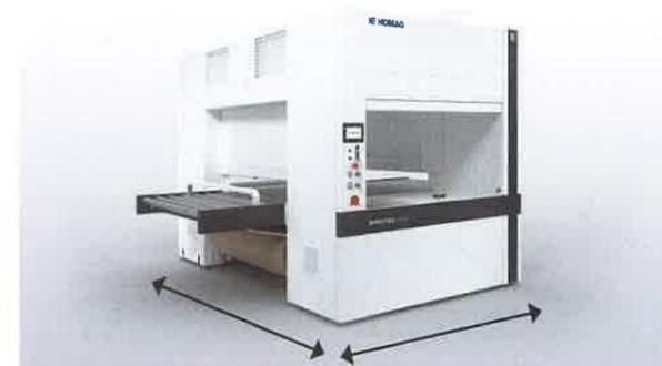
**Geringe Abmessungen:** Das Filter- und Abluftsystem sowie der Schaltschrank sind vollständig in das Maschinengestell integriert. Es gibt keine zusätzlichen Elemente die Platz benötigen oder den Bediener einschränken.
