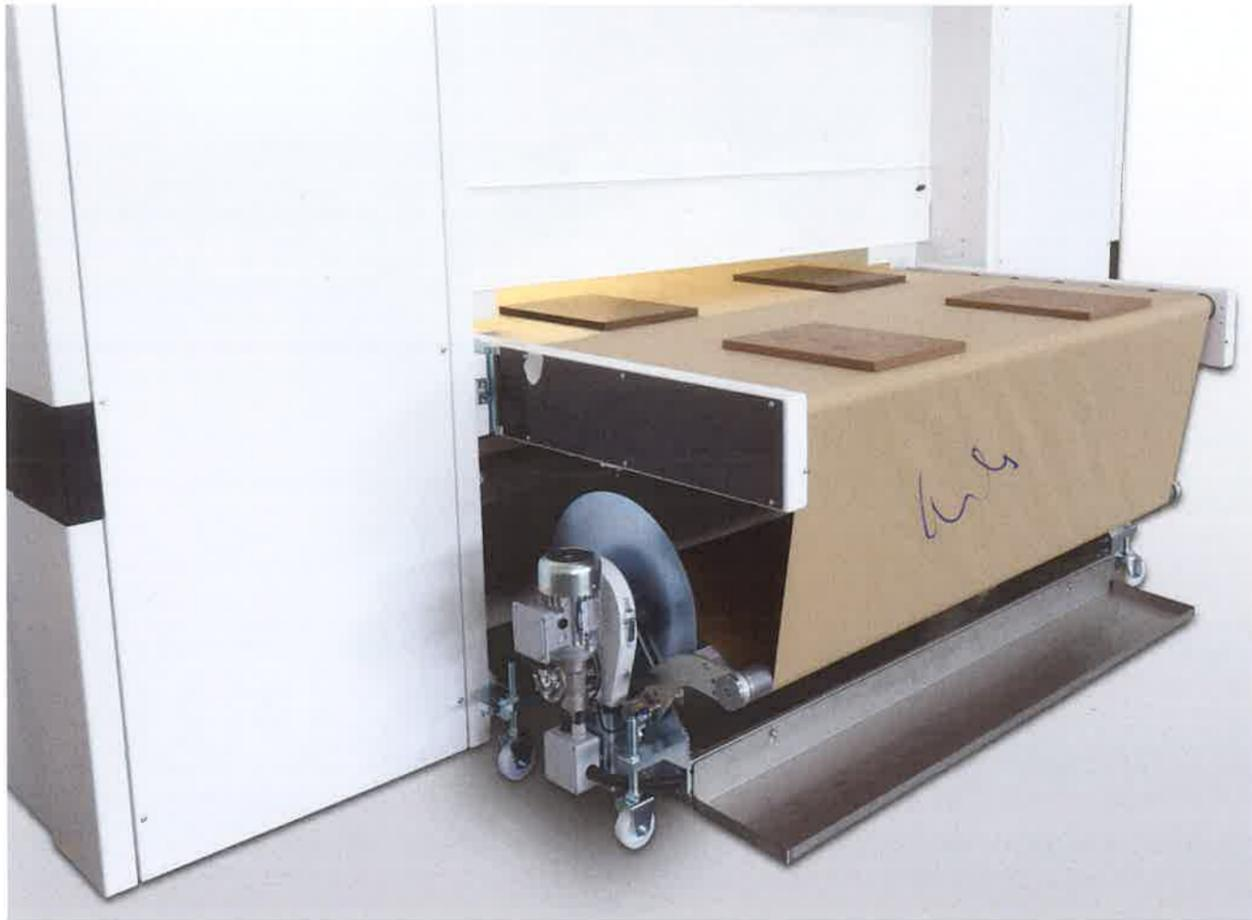
**Transport:** Werkstücke werden mit einem Vakuumtransportband gefördert. Das Einweg-Papier dient nur zur Abdeckung. Dadurch kann sehr dünnes Papier mit mehr Laufmetern auf einer Rolle eingesetzt werden, um den Wartungsaufwand zu verringern. Die Papierspannung wird per Sensor überwacht – mit zusätzlicher Papier-Bruch- und Aufwickelkontrolle.
