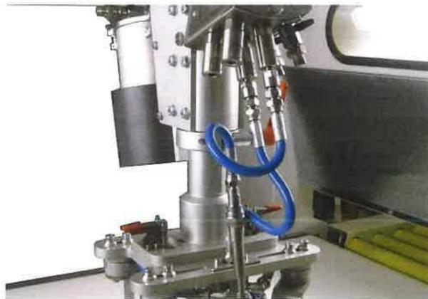
**Zusätzliche Farbkreisläufe:** Zum einfachen Wechsel zwischen unterschiedlichen Farben kann die Maschine mit bis zu vier Farbkreisläufen ausgestattet werden.
