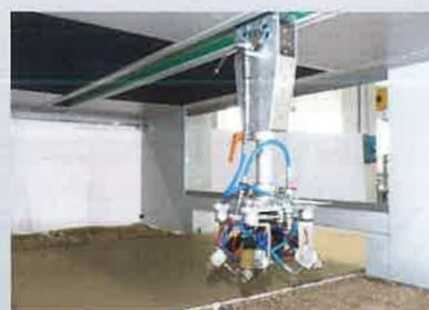
**Schlittenläufer** mit einem Spritzarm für vier Lackierpistolen.
