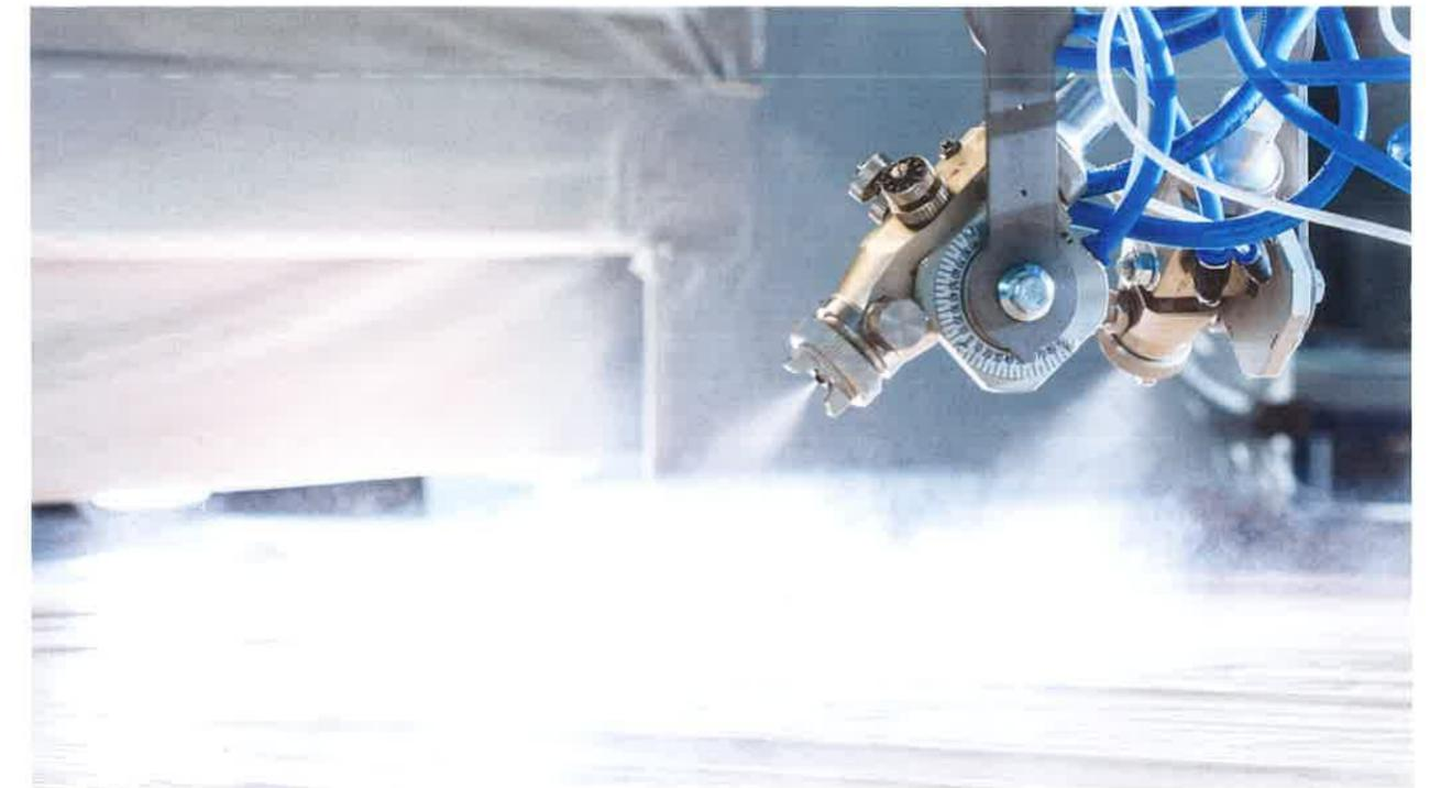
**ROBOSTART P Zelle****Spezielles Roboter Lackiersystem für Türen und profilierte Elemente**
