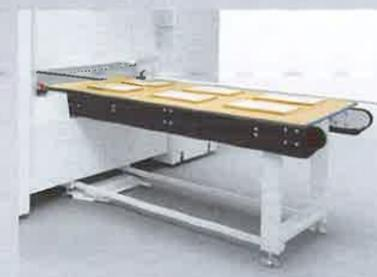
**Werkstückpaletten:** Werkstücke werden auf Paletten liegend durch die Maschine transportiert. Dies ermöglicht das automatische Werkstückhandling und damit die Ein-Personen-Bedienung.
