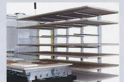
Mit der **Hordenwagenbeschickung** werden Paletten mit darauf liegenden Werkstücken automatisch aus einem Hordenwagen entnommen und nach dem Lackiervorgang wieder in den Hordenwagen abgelegt.
