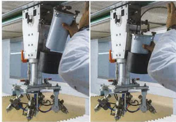
**Kleinmengenversorgung:** Eine ideale Ergänzung beim Lackieren kleiner Losgrößen mit verschiedenen Farben. Der 2-Liter-Behälter wird direkt am Spritzarm montiert und versorgt die Lackierpistolen auf direktem Weg.
