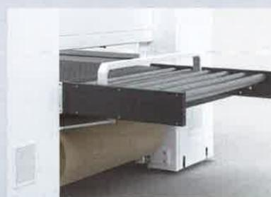
**Vakuumtransport** mit zusätzlicher Papierauflage. Einweg-Papier macht ein aufwendiges Transportreinigungssystem sowie das Reinigen der Maschine bei Chargenwechsel überflüssig.
