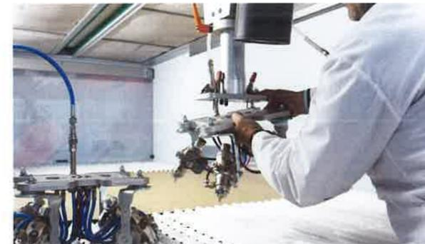
**Pistolenträgerplatte mit Schnellverschluss:** Eine ergonomische und flexible Lösung zum schnellen Wechsel der Pistolen. Die vorbereiteten Pistolenträgerplatten ersparen aufwendiges Montieren und Justieren.
