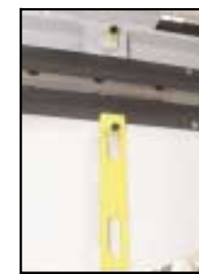
Chiavistello per bloccaggio piani in fase di manutenzione Safety lock Verriegelungshaken für die Heizplatte bei Wartungsarbeiten
