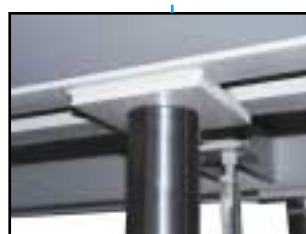
Supporto superiore cilindri libero Cylinder thrust plates obere Zylinder Auflageplatte schwimmend befestigt
