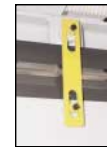
Chiavistello per bloccaggio piani in fase di manutenzione Safety lock Verriegelungshaken für die Heizplatte bei Wartungsarbeiten
